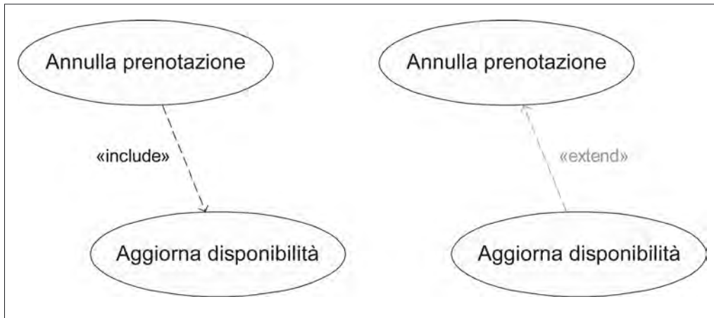
Figura 3.18 — Differenza di notazione tra la relazione di inclusione e quella di estensione.
